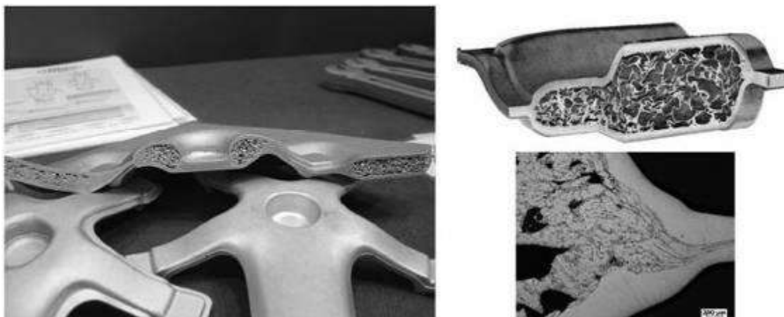
Figura 6: Estruturas sanduíche aplicada à conformação de chapas (Banhart, 2001.).
