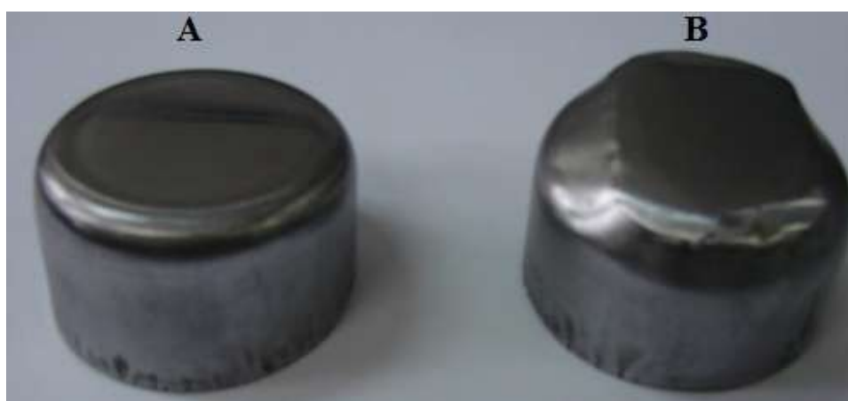
Figura 11: A) Estrutura sanduiche de chapas sem espuma metálica; B) Estrutura metálica com espuma metálica.
