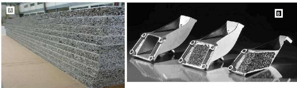
Figura 4: Estruturas Sanduíches: A - Chapas com estruturas sanduíches simples (ALUlight®), B - Estruturas sanduíches complexas (Metcomb® Nanostructures). (Bonaldi, 2012.)
