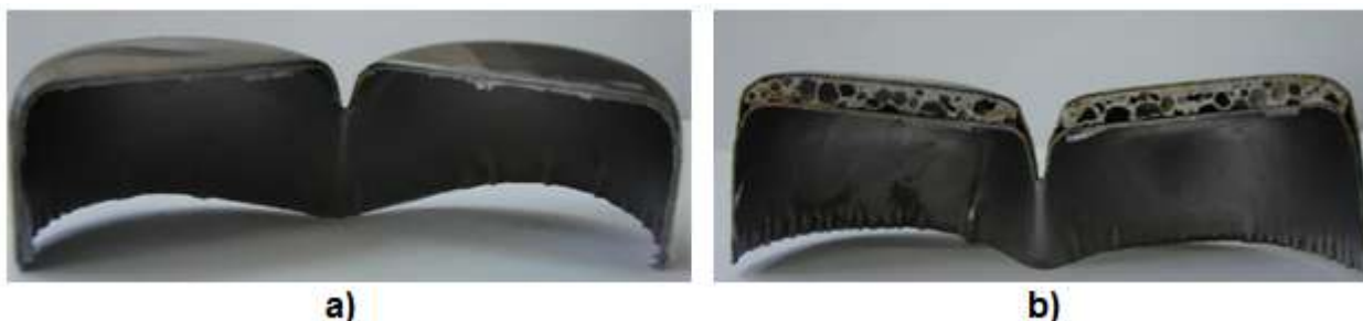
Figura 12: a) Corte da Estrutura sanduiche de chapas sem espuma metálica; b) Corte da estrutura metálica com espuma metálica.
